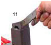
11. Feche a tampa do molde e inicie a ignição com o acendedor. Não use fósforos ou isqueiros. A chama da ignição é rápida e intensa, podendo causar acidentes.
