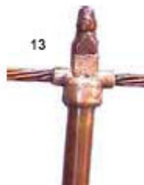
13. As temperaturas atingidas podem exceder os 2200°C. Aguarde tempo suficiente para o resfriamento antes de tocar as partes soldadas.
